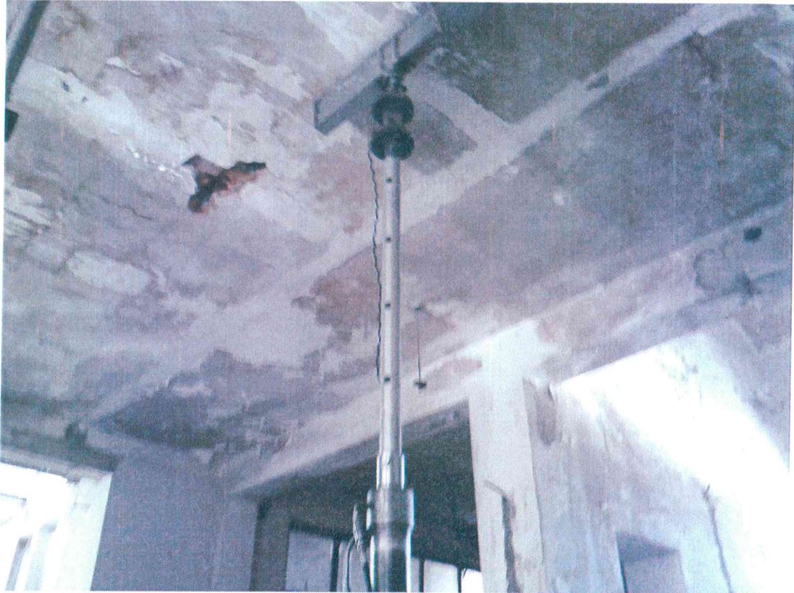
Disposizione per l'applicazione del carico e cella di carico
