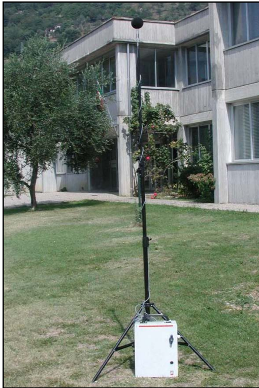
Figura 2 – Vista della centralina mobile SVAN 948 (misure a lungo periodo)
