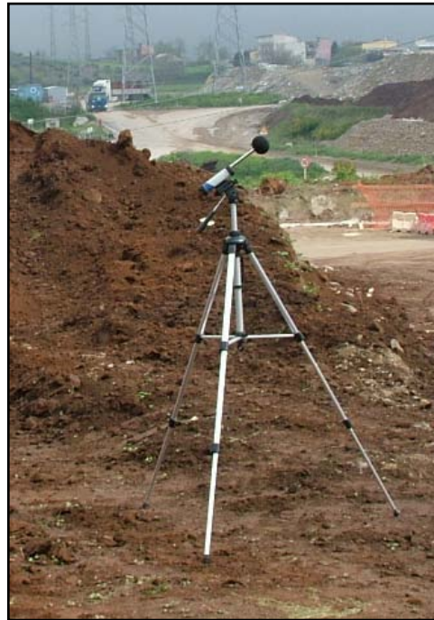
Figura 3 – Vista de fonometro posizionato su treppiede mobile (misure a breve periodo)
